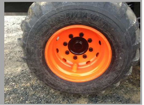
Neumáticos forestales, llantas reforzadas y arilladas
